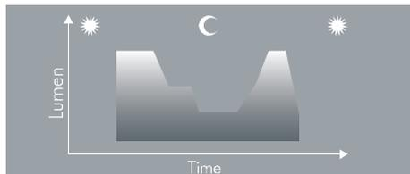
Es können individuelle Dimmprofile angelegt werden. Das DALI Protokoll ermöglicht einen Informationsfluss in zwei Richtungen, so dass einzelne Leuchten überwacht und gesteuert werden können. In DALI Steuerungen können Steuerelemente wie Präsenzmelder und Dämmerungssensoren integriert werden.
