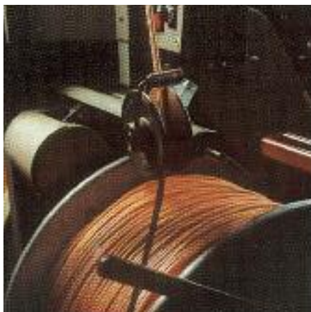
Raccolta cavo schermato.
