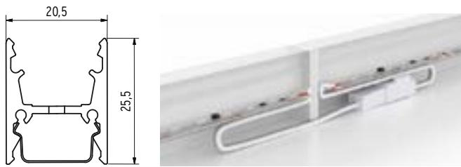
Einfache und saubere Montage durch innenliegenden Montageclip. Zudem dient das H-Profil der ADONIS/KALYPSO auch als Kabelkanal. Daher sind keine Clips oder Kabel von außen sichtbar.
